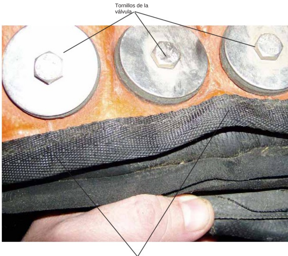
Cincha inferior - cosido a la parte inferior de la Bambi Bucket
